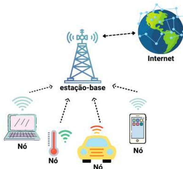
Figura 3 – Arquitetura simples de rede sem fio no modo infraestrutura
