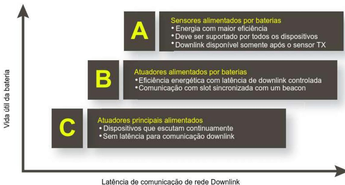
Figura 8 – Classes dos dispositivos LoRaWAN (modificado pelo autor)
